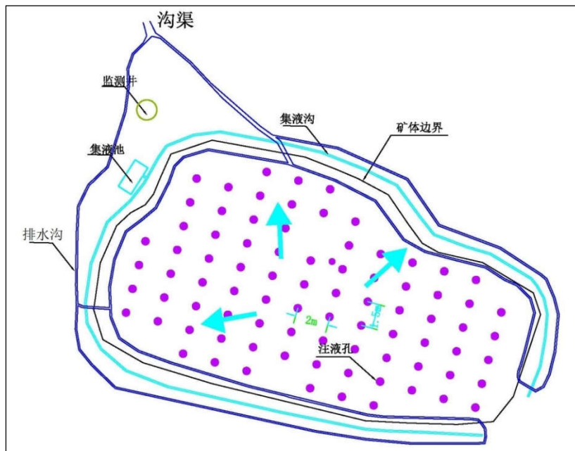
图 6.4-1 各矿块的清污分流示意图
